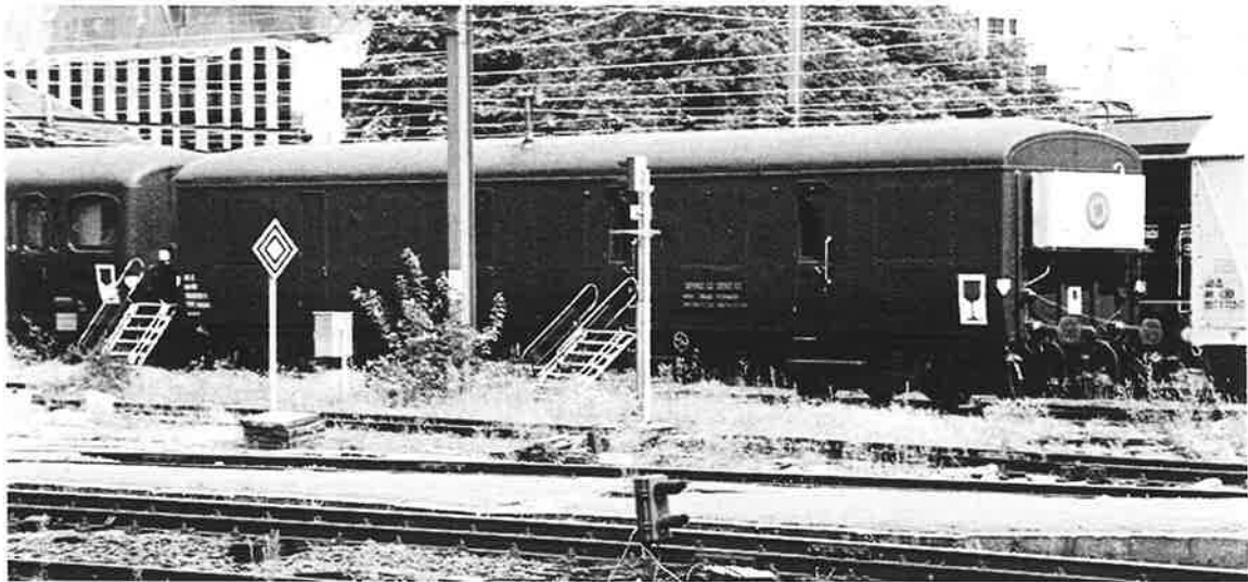
Ci-dessus : voiture voyageurs ex-Nord belge garée sur les voies le long de la rue Wiertz et transformée en voiture de chantier du service ES – Ci-dessous : voiture de la même origine appartenant aussi au service ES, réserve d'eau aménagée sur la paroi, non ce n'est pas une cible pour le tir à l'arc !
